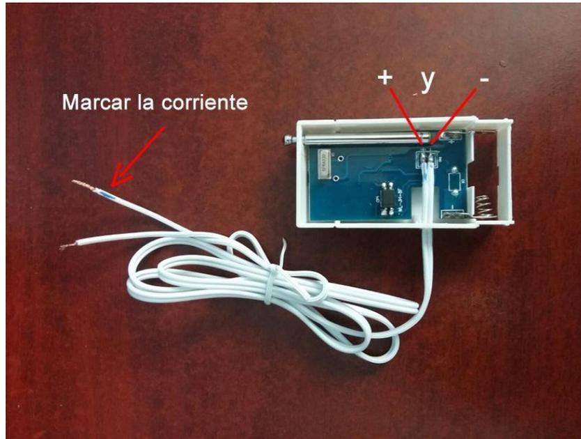
Con el panel apagado hay que conectar en la parte de atras del panel donde indica Siren + y -
