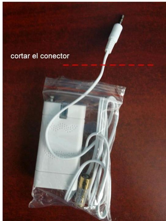
Una vez el conector cortado, hay que retirar el plástico de la punta para tener los cables listos para conectar al panel.
