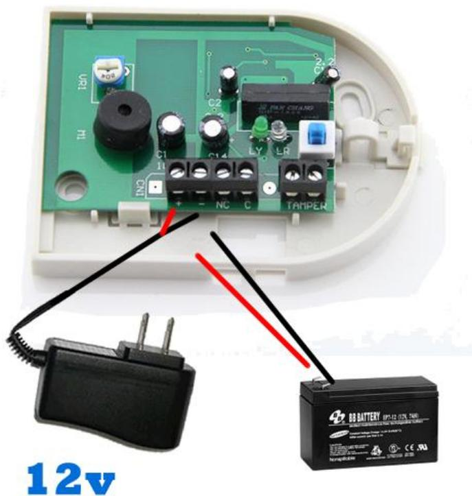
Si usted requiere tener la corriente 12v desde el panel, tiene que conectar TIERRA y CORRIENTE que esta detrás del panel.
